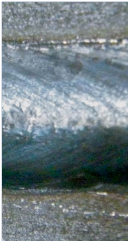
Рис. 8. Внешний вид сварного шва, сформированного на монтажных кромках, окрашенных грунтовкой Muki Z 2001
